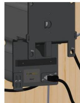
Zum Anschluss (Ihrer eigenen) Drucktasten oder Hausautomation wird das Kabel der eigenen Drucktasten verwendet. Dieses verfügt über drei offene Kabelenden, eines für die Aufwärtsbewegung (blau/weiß), eines für die Abwärtsbewegung (braun) und die Ausgangsspannung (blau). (Es ist also keine externe Spannungsquelle erforderlich.)
